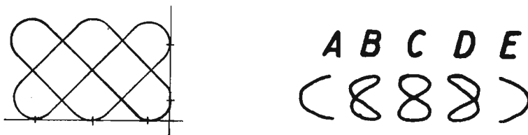
Figg. 3.2 e 3.3 - Figure di Lissajous visibili con l'oscilloscopio da 3 pollici.
