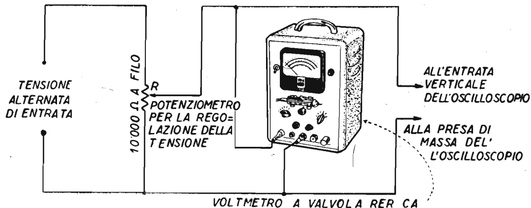
Fig. 5.6 - Disposizione per la calibrazione dell'oscilloscopio con voltmetro a valvola.
