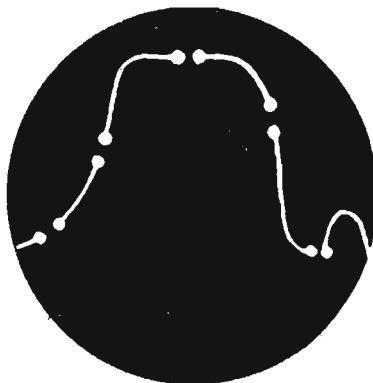
Fig. 5.17 - Marcatura della frequenza lungo una curva di responso con il sistema della modulazione di intensità.
