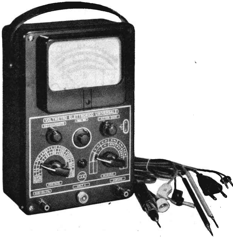
Fig. 9.1 - Esempio di voltmetro a valvola, adatto per la misura di tensioni continue, alternate ed oscillanti, nonchè di resistenze.
